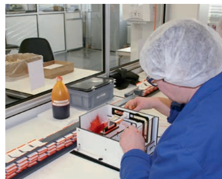
Imprägnieren von Teststreifen mit einem Reagenz. Die Streifen kommen in der Augendiagnostik zum Einsatz.
